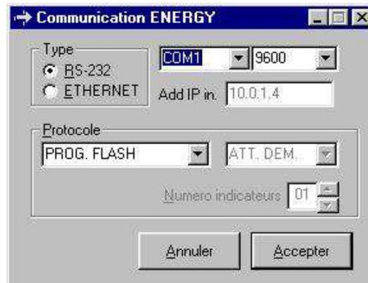
Choisir le port de communication du PC sur lequel sera connecté l'indicateur ainsi que la vitesse en Bauds de la connexion ( celle ci devra être la même que celle configurée dans l'indicateur ). Les autres paramètres de communications configurés dans l'indicateur devront être: **Parité: NO, 8 bits de données et 1 bit de STOP.**
